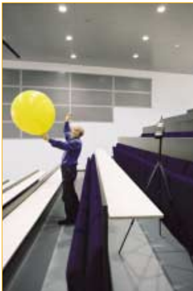
SLIKA 7 Preizkus odmevnega časa v avditoriju
