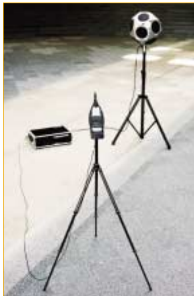
SLIKA 8 Oprema za akustično analizo prostora
