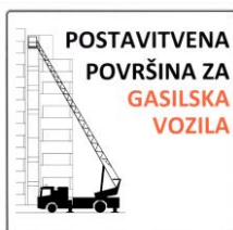
Slika 13: Znak za postavitveno površino za gasilska vozila
