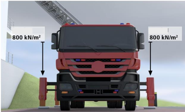
Slika 6: Točkovna obtežba na postavitveni površini pri stabilizaciji gasilske lestve: 800 kN/m 2 .
