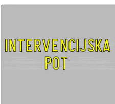
Slika 10: Talna označba INTERVENCIJSKA POT po Pravilniku o prometni signalizaciji in prometni opremi na cestah (napis na prometni površini št. 5510)
