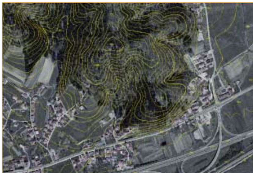
SLIKA 4 Digitalni ortofoto načrt s pretiskom plastnic, hidrografije in stavb
