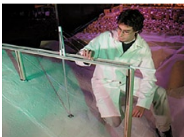
Slika 3: Preizkusi v vetrovniku: model terena, model konstrukcije v fazi gradnje, model protivetrne ograje
