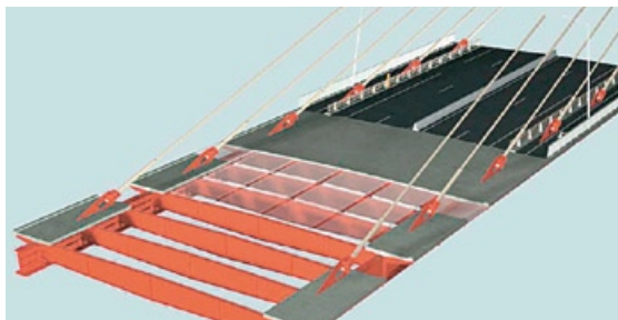
Slika 9: Zasnova sovprežne voziščne konstrukcije
