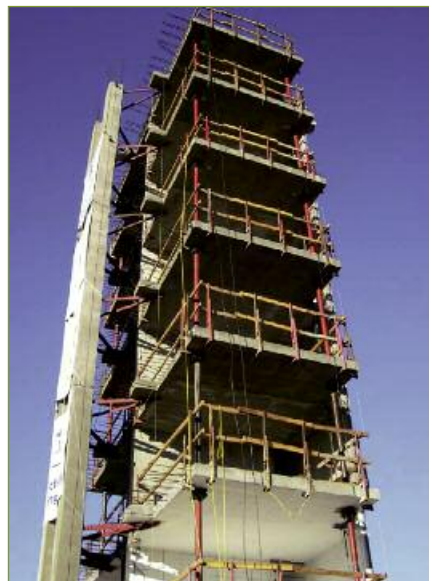
SLIKA 3 Na potresni mizi UC San Diego je bila preizkušena 22 m visoka stena. Slovenski raziskovalci so vnaprej najbolje napovedali odziv
