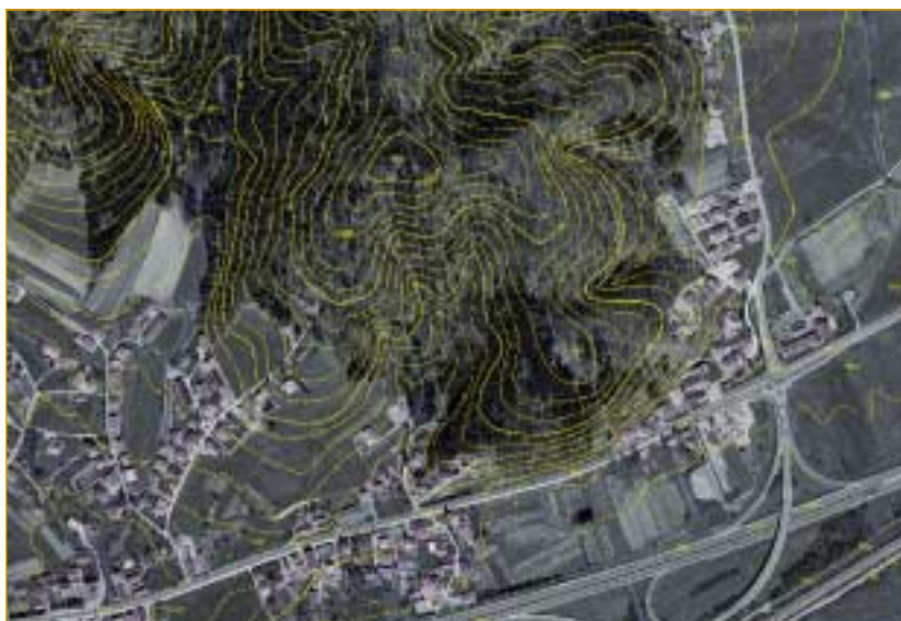
SLIKA 4 Digitalni ortofoto načrt s pretiskom plastnic, hidrografije in stavb
