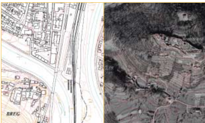
SLIKA 10: Geodetske podlage za prikaz prostorskih aktov na podlagi TOP05 in digitalnega ortofoto načrta (rastr)
