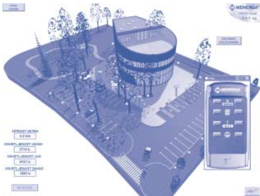
Slika 8: Centralni nadzorni sistem - zunanji parametri, virtualni tabli za individualno nastavljanje parametrov
