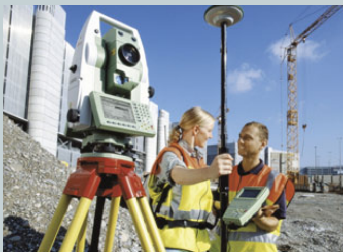
Po praksi v Sloveniji, je dovoljeno objekte zakoličiti tudi z GPS napravami. Na sliki je model Leica GPS 1200.
