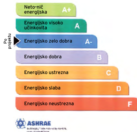
Slika 1: Energetsko razvrščanje stavb po načinu ASHRAE.
