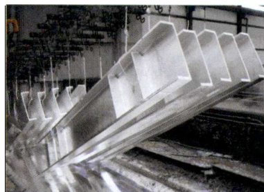
Vroče cinkanje je ena izmed najstarejših oblik protikorozijske zaščite.
