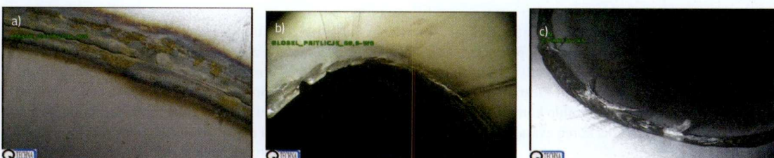
» Slika 6: Primeri iz prakse a) Nепreverjenost v obarvanosti v korenu; b) Vključki; c) Neenakomeren koren zvara
