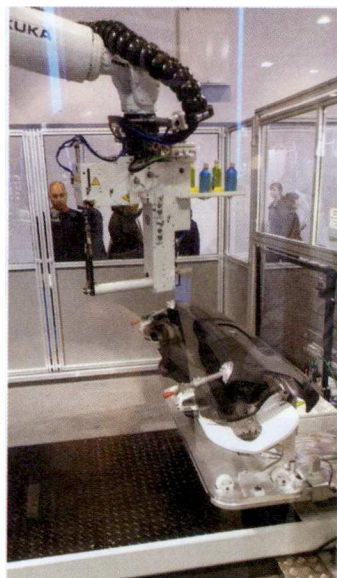
Robotna celica za šivanje pri izdelavi armaturne plošče
