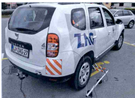
Slika 1. Merjenje z metodo SPB (med meritvijo).
