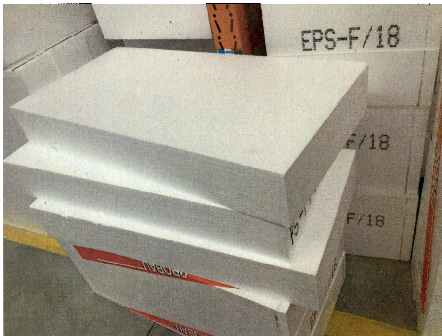
Ekspandirani polistiren (EPS) ali stiropor je sintetični polimer, proizveden iz nafte, in je med najbolj pogosto uporabljenimi plastičnimi masami. Foto: dokumentacija Dnevnika
