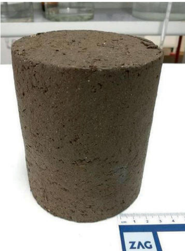
Slika 3: Kompozit iz komunalnega blata in pepela (foto vir: ZAG).
