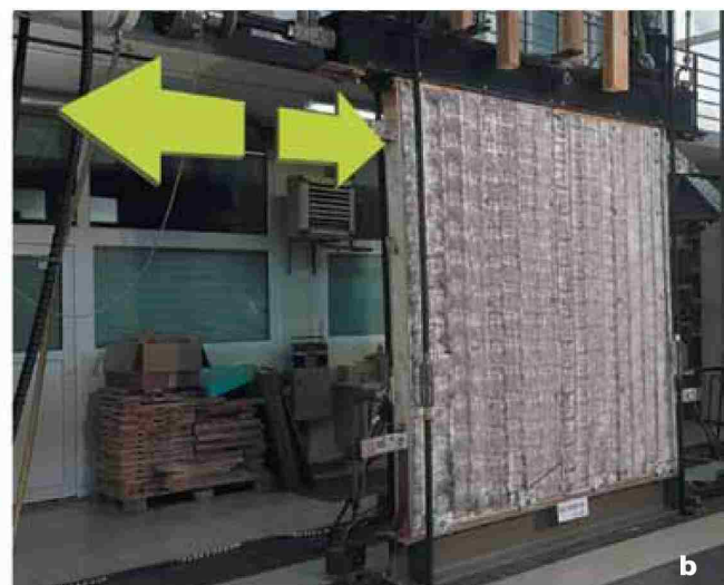
Slika 1 : Prikaz malega vzorca med preskušanjem [a] in stenskega panela dejanske velikosti [b].
