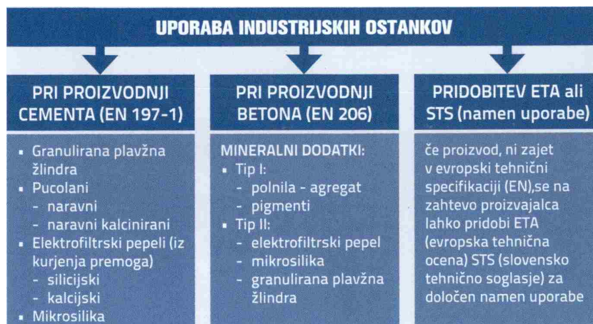
Slika 3: Shema vrednotenja uporabe industrijskih ostankov za primer cementa in betona.
