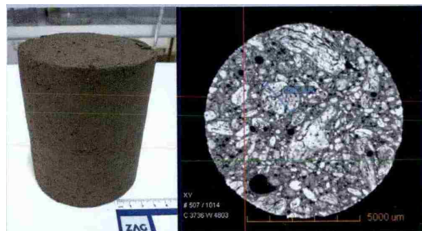
Slika 1: Laboratorijski vzorec geotehničnega kompozita iz komunalnega blata in alkalnega hidravličnega veziva - levo in prečni prerez mikrotomografskega posnetek kompozita - desno (vir: ZAG).
