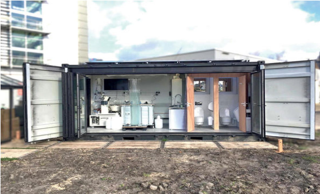
Slika 2: Pilotna naprava za ekstrakcijo hranil iz urina – levi del slike je laboratorij za ekstrakcijo, desno je stranišče (vir: TUDelft)
