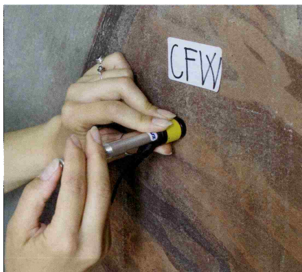
Slika 2: In-situ merjenje površinske trdote po utrjevanju (foto: Sabina Kramar)
