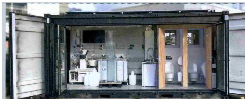
Slika 2: Pilotna naprava za ekstrakcijo hranil iz urina – levi del slike je laboratorij za ekstrakcijo, desno je stranišče (vir: TUDelft)
