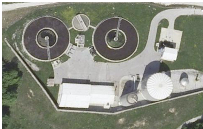
Slika 14 • Čistilna naprava Laško z aerobno stabilizacijo blata in predčiščenjem odpadne vode Pivovarne Laško na UASB-reaktorju
