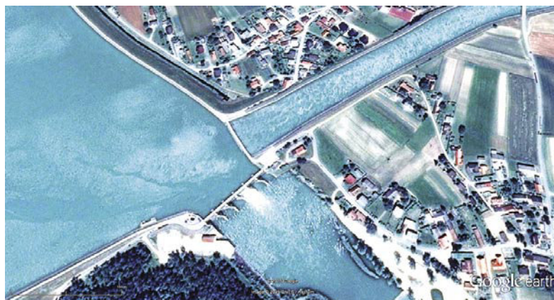
Slika 3 • Jez HE Formin s spodnjo Dravo in energetskim kanalom do HE Formin. Malo HE, po predlogu projektanta, pa so končno (levo do jezcu) po mnogih letih le zgradili
