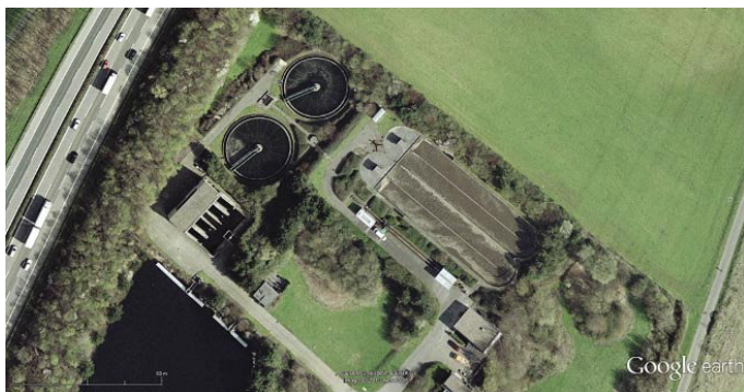
Slika 11 • ČN Herbede na Ruhru. Nitrifikacija in denitrifikacija brez anaerobnih reaktorjev
