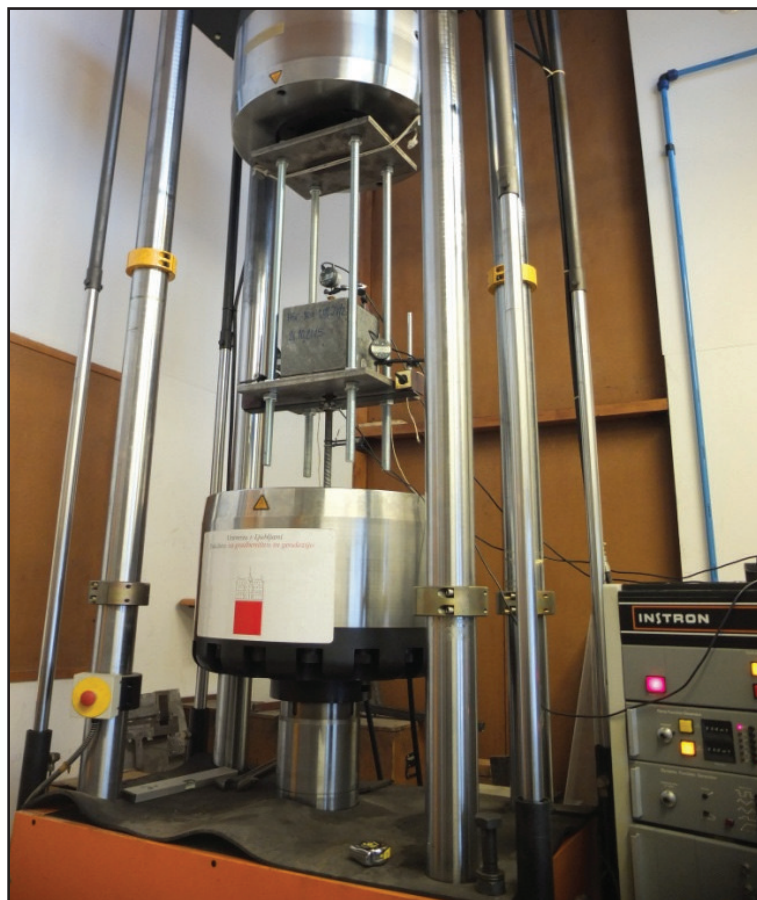
Slika 4 • Naprava za izvedbo izvlečnega testa (angl. pull-out testa) in geometrijski podatki preizkušanca.
