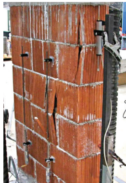
Slika 3 • Tlačna porušitev preizkušanca.
