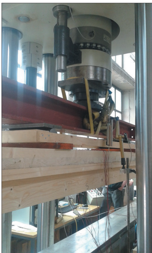
Slika 5 • Plošča med testom (levo); lokacija podpor in vnosa obtežbe (desno); mere so v cm
