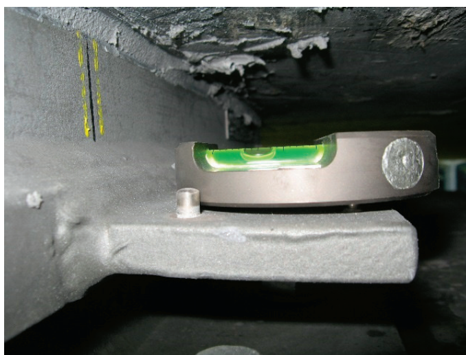
Slika 9 • Meritev drsne reže ležišča (levo), meritev ravnosti s tritočkovno precizno vodno tehtnico (desno).
