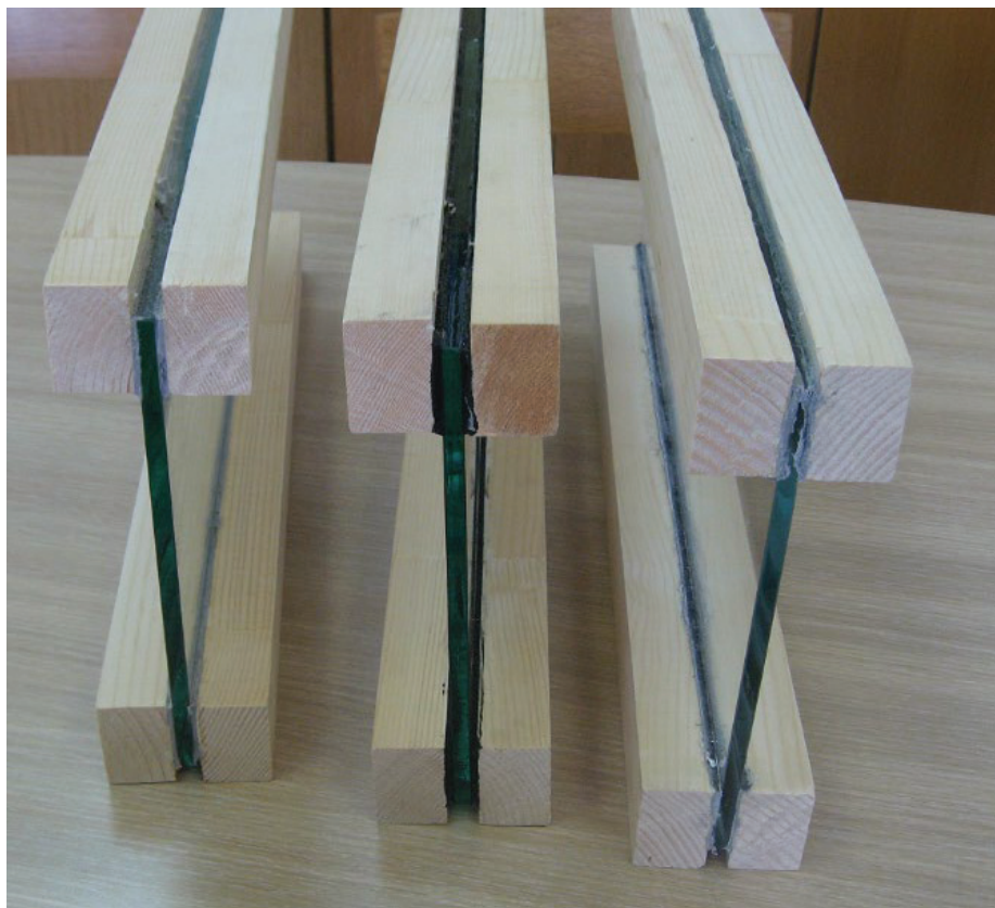
Slika 12 • Povezava les-steklo, adhezivi: epoksi, silikon, akrilat.
