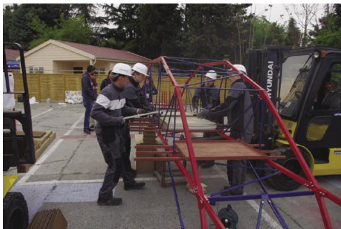
Slika 15 • Obremenitev mosta z jeklenimi ploščami mase 1000 kg
