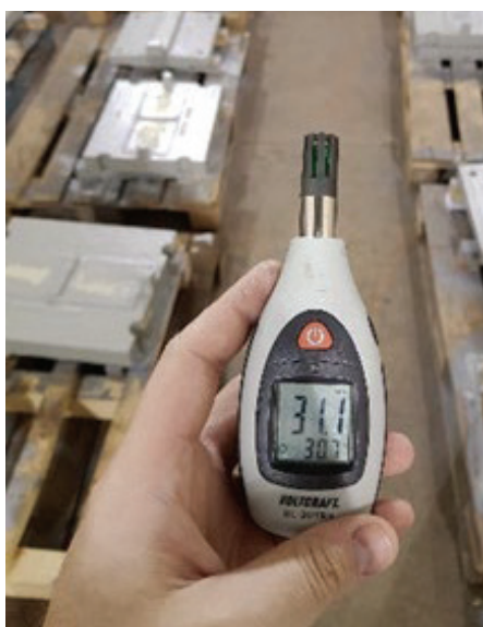
Slika 17 • Kontrola temperature in vlažnosti v barvalni komori.
