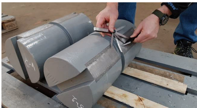
Slika 20 • Merjenje ravnosti (levo) in hrapavosti (desno) na kontaktnih površinah med deli ležišč.
