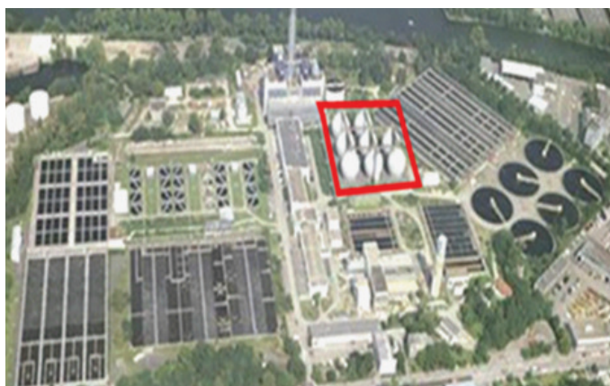
Slika 25 • Čistilna naprava Ruhleben, Berlin za 1,6 mio. PE. Na tej napravi so opustili proizvodnjo bioplina v 8 gniliščih z 52.000 m 3 prostornine. anaerobnih reaktorjev za bioplin (Rismal, 2015).
