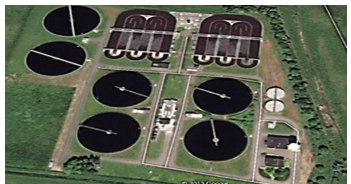
Slika 19 • Č. n. Zwijndrecht 200.000 PE z isto tehnologijo zgrajene ptujске č. n. brez uporabe vodne moči, kot je bila na voljo na dravskem jezu HE Formin v Markovcih.
