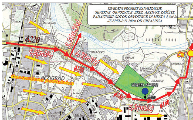
Slika 32 • Z dragim, 5 km dolgim cevovodom Ø180 iz duktilne litine za 5,3 m³/s padavinskega odtoka iz celotne obvoznice mimo vodarne ljubljanskega vodovoda v Hrasnju, 200 od vodarne, je varnost črpne podtalnice dodatno ogrožena (Rimal, 1999).
