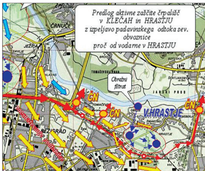
Slika 33 • Vodnogospodarsko in ekološko podprti načrt za bogatenje in istočasno zaščito pitne podtalnice vodarne v Hrasnju s filtratom Save pred severno obvoznico in onesnaženo podtalnico izpod mesta (Rimal, 1999).
