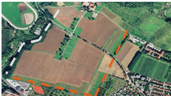
Slika 29 • Linija (bela) zgrajenih nalivalnih vodnjakov za bogatenje podtalnice na Vrbanškem platoju. Linija nalivalnih vodnjakov (rdeča) za zaščito pred vplivi mesta tudi po 30 letih ni zgrajena (Rismal, 2018).
