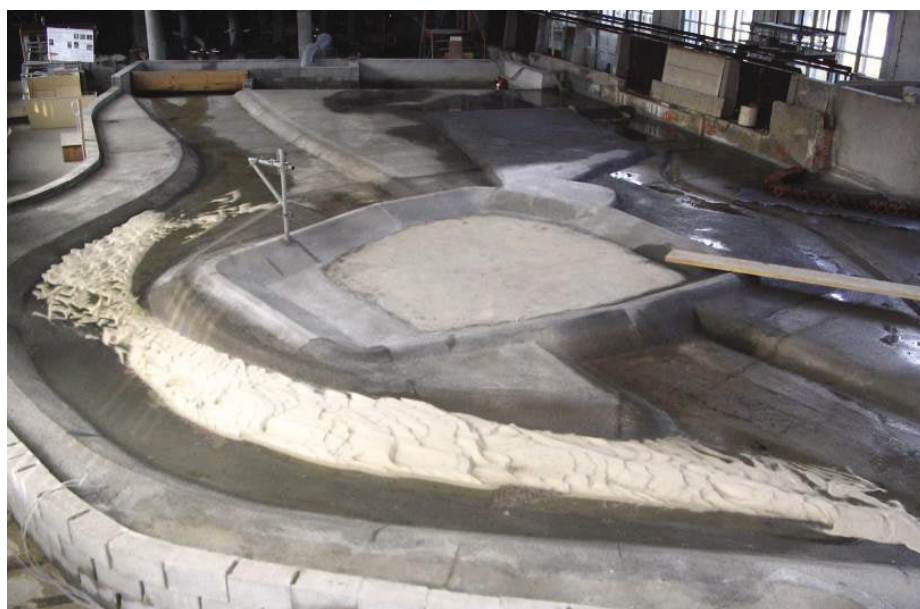
Slika 3 • Fizični model gradbene jame HE Brežice (Hidroinštitut, 2011)
