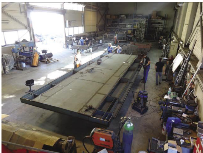
Slika 24 • Izdelava prvega segmenta (levo) in poskusna montaža pohodnih panelov (desno)
