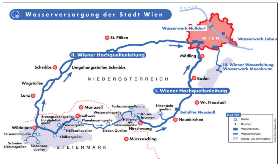
Slika 4 • Dunajski vodovod s I. cevovodom iz višinskega platoja Raxa in Schneeberga in pozneje zgrajenim II. cevovodom z območja Wildalpen. Modro so obarvana vodovarstvena območja.
