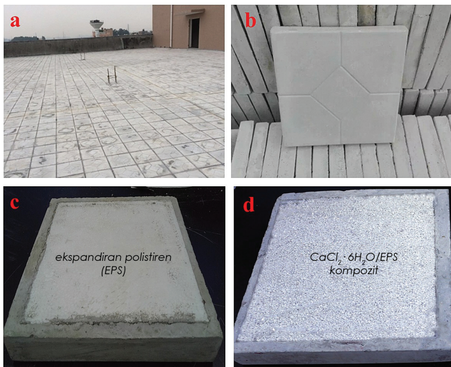
Slika 12 • Uporaba betonskih plošč na strehi (a), betonski zgornji del plošče (b), običajna betonska plošča z ekspanziranim polistirenom (c) in betonska plošča s \text{CaCl}_2 \cdot 6\text{H}_2\text{O}/\text{EPS} kompozitom (d) (povzeto po (Fu, 2017)).
