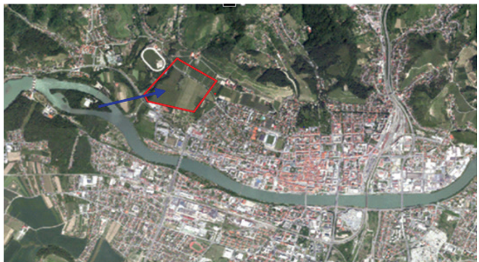
Slika 12 • Območje vodarne na Vrbanškem platoju v neposredni bližini mesta Maribor je po načrtu (slike 13 do 18) zaščiteno pred vplivi iz mesta. Podtalnica se po načrtu bogati z obrežnim filtratom iz Mariborskega otoka, obrežnih vodnjakov Drave in po potrebi z očiščeno dravsko vodo (slika 14). Izvedeno pa je le bogatjenje z obrežnim filtratom in iz Mariborskega otoka.
