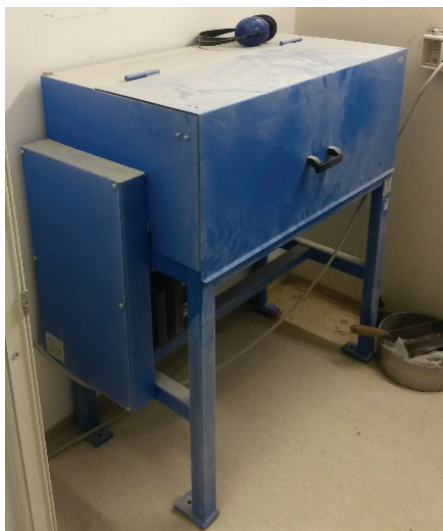
Slika 7 • Naprava Micro-Deval (levo) in vzorec, pripravljen na testiranje (desno) na ZAG Slovenije.
