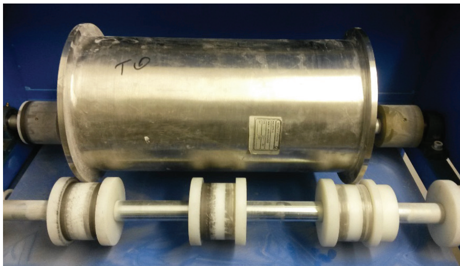
Slika 7 • Naprava Micro-Deval (levo) in vzorec, pripravljen na testiranje (desno) na ZAG Slovenije.
