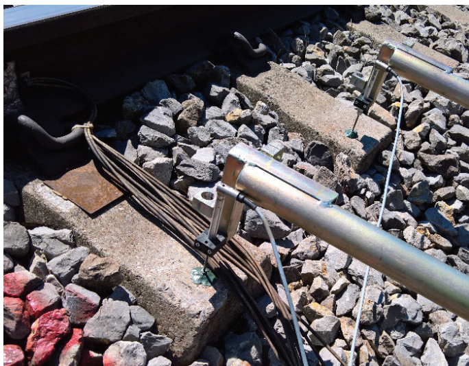
Slika 2 • Meritve pomikov na nekritičnem merskem mestu MM1 in že delno kritičnem merskem mestu MM2.
