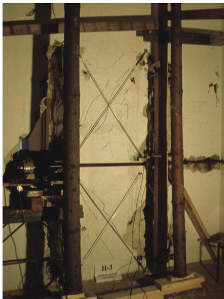
Slika 10 • Značilna zasnova terenske preiskave kamnitega zidu. V zidu se vidijo diagonalno usmerjene razpoke (Tomažević, 2000). (Fotografija: M. Tomažević)
