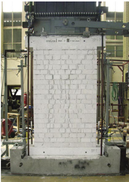
Slika 14 • Del navpične sile se v zid vnaša s prednapetimi zunanji vezmi, ki hkrati preprečujejo tudi njegovo vrtenje. Zid se poruši strižno brez vrtenja in sekundarnih poškodb. (Fotografija: Arhiv ZAG)
