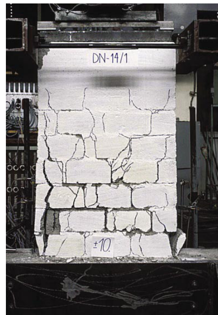
Slika 29 • Duktilna strižna porušitev nizkega zidu, armiranega z navpično armaturo po robovih in vodoravno armaturo v naležnih regah (Fotografija: M. Tomažević)
