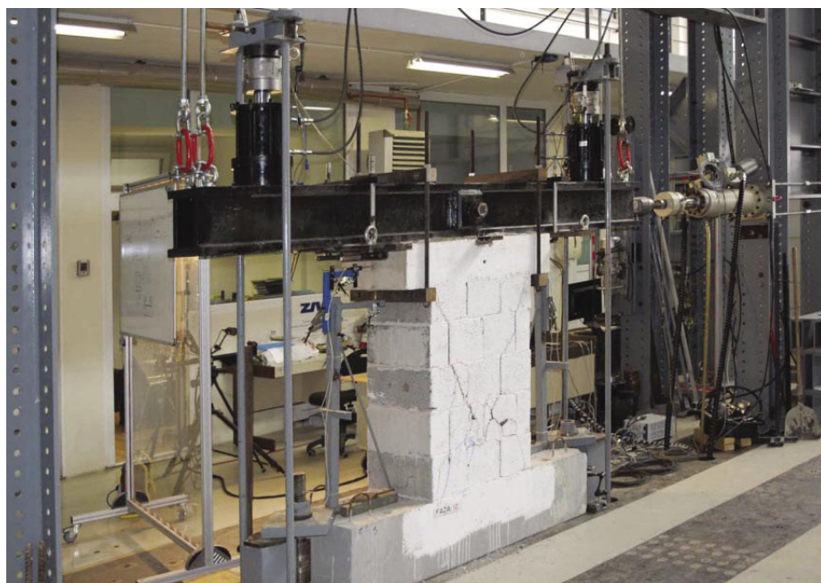
Slika 15 • Ciklična strižna preiskava zidu, med katero se s sistemom hidravličnih batov uravnavajo robni pogoji. Zid se poruši strižno brez vrtenja in sekundarnih poškodb. (Fotografija: Arhiv ZAG)
