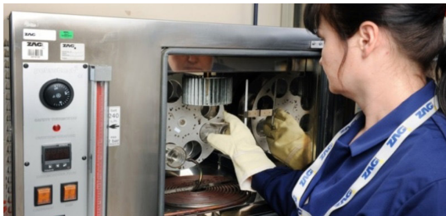
Slika 3 • RTFOT-postopek kratkotrajnega staranja (laboratorij ZAG Ljubljana).
