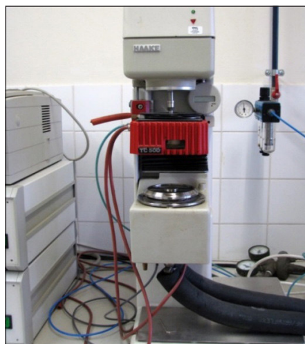
Slika 5 • Dinamični strižni reometer (laboratorij ZAG Ljubljana).
