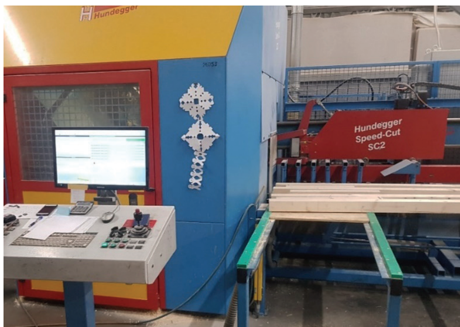
Slika 14 • Uvoz podatkov na stroj Hundegger Speed-Cut in razrez lesa.
