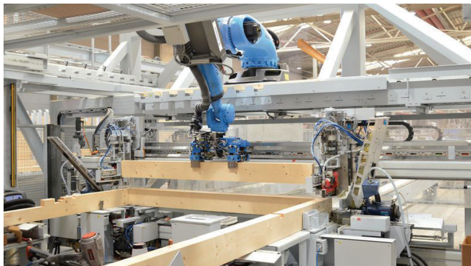
Slika 16 • Robot v lesni okvirni gradnji (Homag, 2019).
