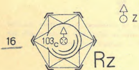
Rezervoar - toranj za vodu (rešetkast gvozden)(257)
