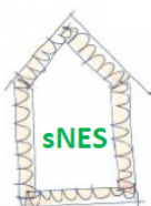
Stavba s 25 cm toplotne izolacije
