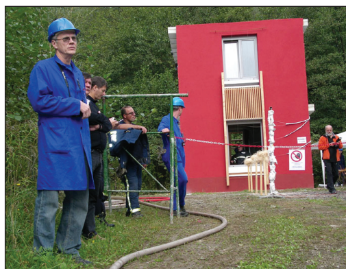
Požarni preskus fasade na Igu (foto SZPV)
