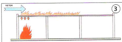
Mehanizem vpliva vetra na širjenje požara po strehi
