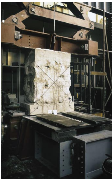
Slika 18 • Ciklična strižna preiskava kamnitega zidu v laboratoriju (Fotografija: M. Tomažević)
