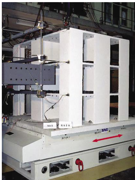
Slika 20 • Nova potresna miza z modelom, pripravljenim na preiskavo (Fotografija: M. Tomažević)
