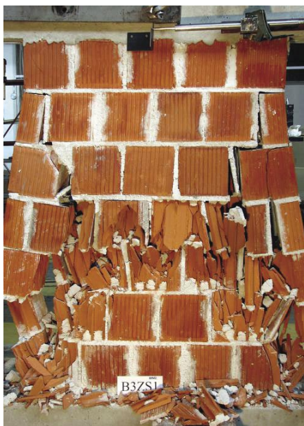
Slika 23 • Drobljenje krhkih zidakov je imelo za posledico tudi krhko strižno porušitev zidu. (Fotografija: Arhiv ZAG)
