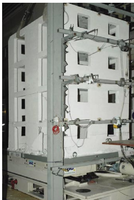
Slika 25 • Preiskava modela 4-etažne hiše iz porobetona na potresni mizi (Fotografija: Arhiv ZAG)
