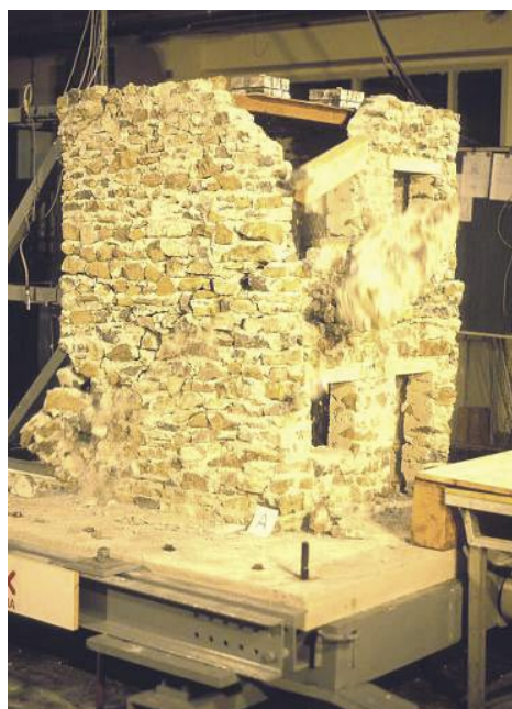
Slika 17 • Porušna faza preiskave modelov kamnitih hiš na potresni mizi: model brez zidnih vezi (levo) in model s povezanim zidovjem (desno) (Fotografiji: M. Tomaževič)
