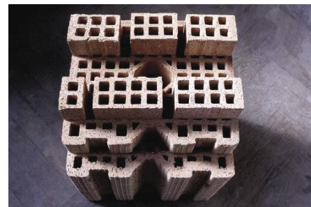
Slika 7 • Izdelava modelnih zidakov z razrezom prototipnega votlaka (Fotografija: M. Tomaževič)
