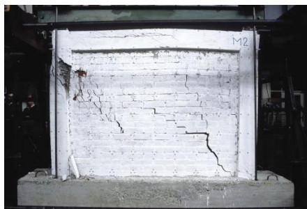
Slika 14 • Porušni mehanizem okvirja z zidanim polnilom. Na preizkušancu so vidne tarče, nalepljene za fotogrametrične meritve. (Fotografija: M. Tomažević)
