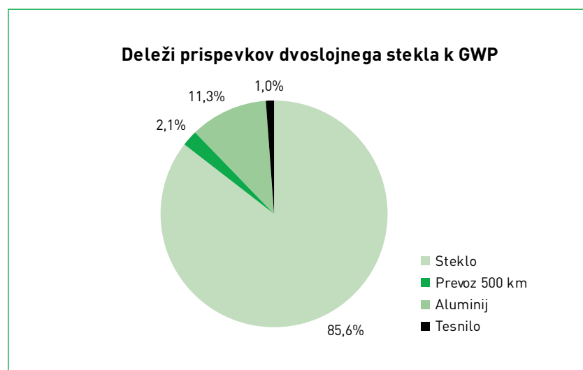
SLIKA 1a IN 1b: Rezultat analize za dvoslojno steklo – GWP v kg CO 2 ekv.
