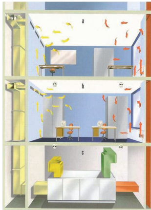
Slika 113: Sistem prezračevanja in klimatizacije, ki lahko deluje tudi kot MODT, če je ustrezno dimenzioniran
