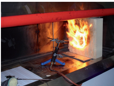
Slika 45: Reakcija polnila fasadnih oz. strešnih plošč iz poli-izo-cianurata na plamen in visoko temperaturo
