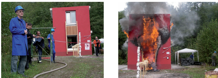
Slika 40: Požarni preskus fasade
