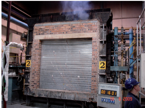
Slika 41: Dokaz požarne odpornosti dviznih vrat
