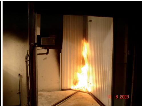
Slika 44: Požarni preskus fasadnega panela po metodi SBI
