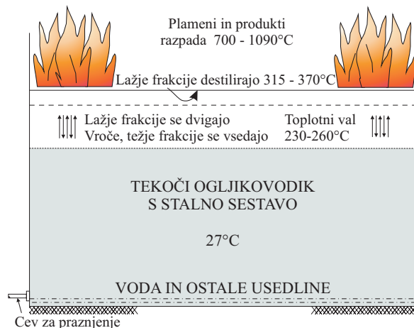
Slika 26: Širjenje toplotnega vala pri požarih težjih naftnih frakcij v rezervoarjih
