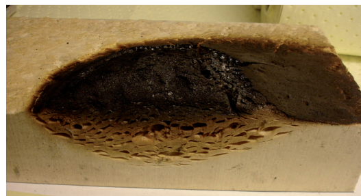
Slika 45: Reakcija polnila fasadnih oz. strešnih plošč iz poli-izo-cianurata na plamen in visoko temperaturo
