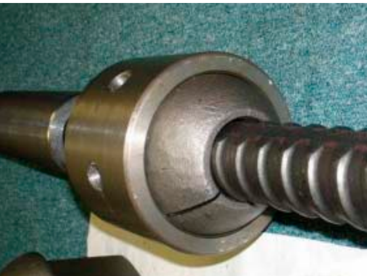
Slika 5 in 6: Ključna elementa, ki zagotavljata delovanje sistema prerezana kupolasta matica in podložka z objemkami.
