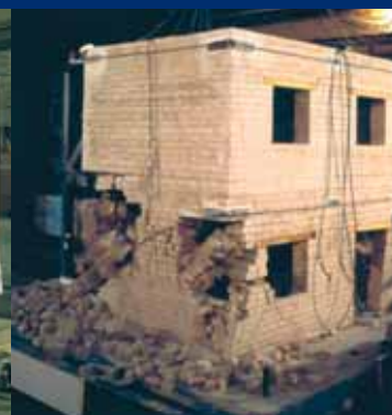
Zidne vezi spremenijo mehanizem, zagotovijo celovitost obnašanja konstrukcije in s tem izrabo nosilnosti zidovja
