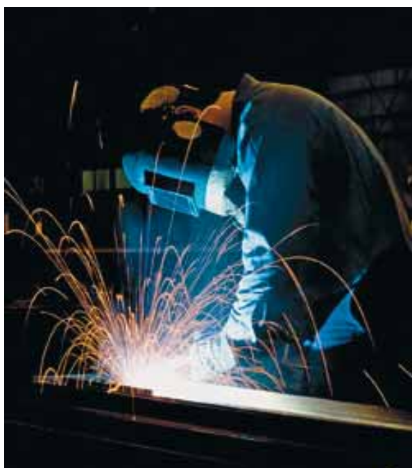
Slika 9: Pri varjenju se sprošča več milijonov nanodelcev na vsak \text{cm}^3 zraka.
