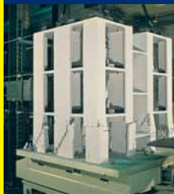
1 Model trinadstropne zidane stavbe med preiskavo na potresni mizi
