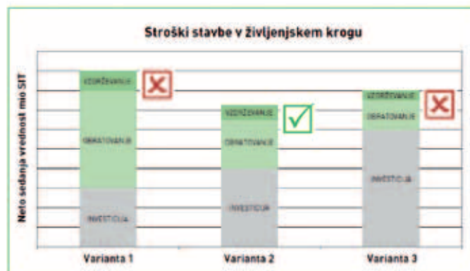
Slika 2: Presoja različnih scenarijev gradnje stavbe na podlagi LCC analize izlušči najcenejšo rešitev v celotnem življenjskem krogu stavbe.
