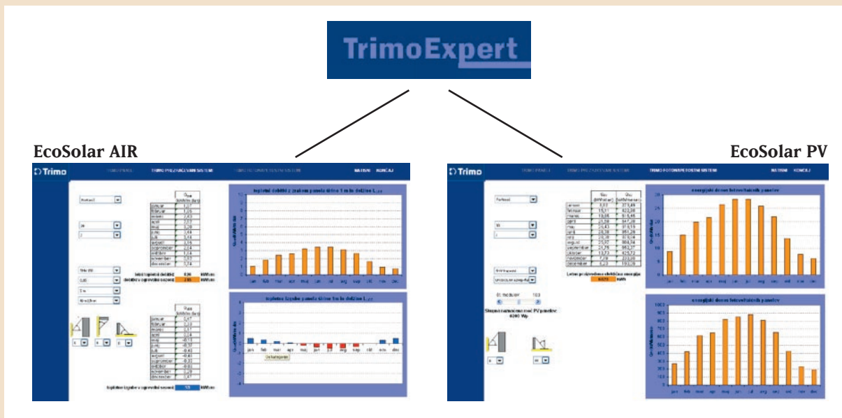
Slika 6: Računalniški program Trimo Expert za izdelavo poročila o toplotnih lastnosti stavbe ter modula za izračun toplotnih dobitkov EcoSolar AIR panela in proizvedene električne energije z EcoSolar PV panelom
