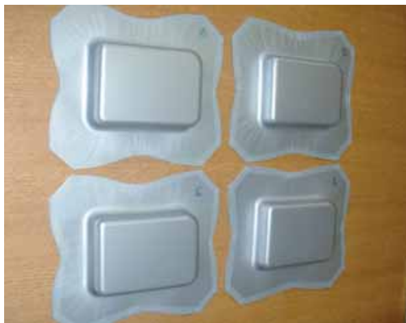
Slika 6: Vzorci predlakirane pločevine po globokem vleku z različnimi radiji vogalov (5, 8, 10 in 15 mm)
