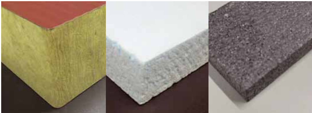
Slika 1: Izolacijski materiali - mineralna volna (levo), ekspandiran polistiren (na sredini) in ekspandiran polistiren z absorberji toplotnega sevanja znotraj materiala (desno)
