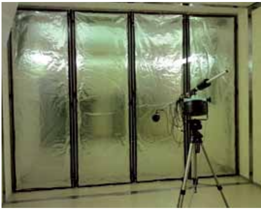
Slika 5: Testiranje zvočne izolativnosti visokoizolacijskih tankoslojnih panelov, R_w=48 dB
