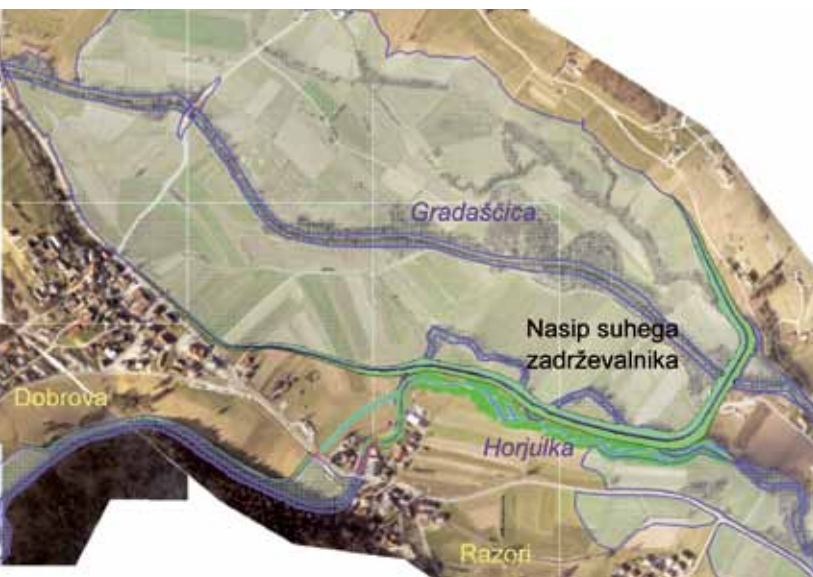
Slika 8: Suhi zadrževalnik Razori pri Dobrovi s prostornino 1,2 \cdot 10^6 \text{ m}^3
