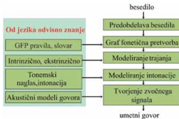
Slika 2: Splošna struktura sistema za samodejno tvorjenje govora
