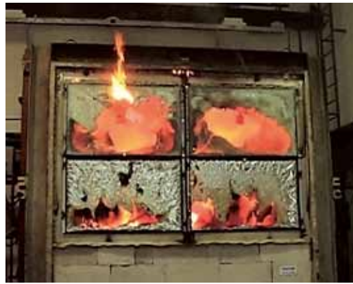
Slika 6: Testiranje požarne obstojnosti visokoizolacijskih tankoslojnih panelov, EI60
